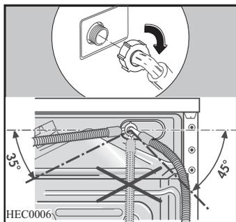
**2** Stellen Sie den Schlauch durch Lockern der Ringmutter richtig ein. Ziehen Sie die Ringmutter nach dem Positionieren des Zulaufschlauchs wieder fest, um Wasser Austritt zu vermeiden.
